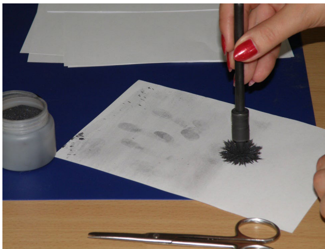
Ryc. 4. Ujawnianie śladów linii papilarnych za pomocą proszku ferromagnetycznego na papierze
