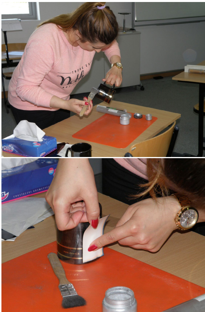
Ryc. 2, 3. Ujawnianie śladów linii papilarnych za pomocą proszku aluminiowego i zabezpieczanie ich przy wykorzystaniu folii żelatynowej
